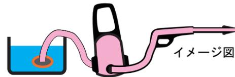
「呼び水」作業をして、全て水でみだされている状態にすると圧力が安定します。
