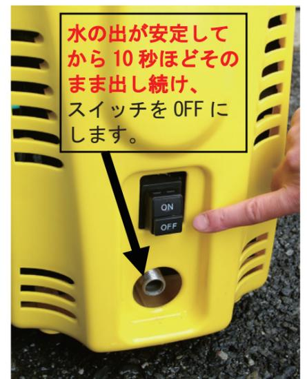
※ 使用途中でため水が少なくなり、ストレーナーから空気を吸ってしまった場合も再度この「呼び水」作業をして下さい。
