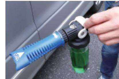
洗剤量レバーは最初 OFF の位置にしておき、噴射しながら動かして調整する
