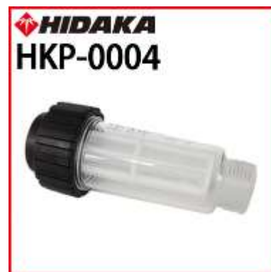
フィルターボトル (HKP-0004) 井戸水やため水を吸い上げる際に、本体にゴミが入ることを防ぎます。 ※自吸セット (HKP-JSET) に含まれます。
