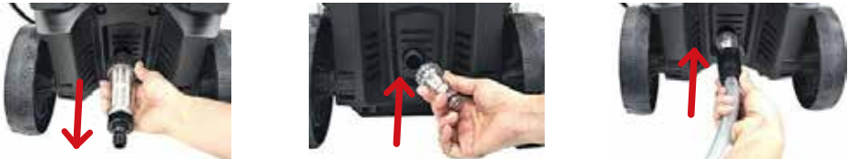
フィルターボトルを取りはずします。 → 本体側（凸型）カップリングを取り付けます。 → 自吸用ホースを接続します。
