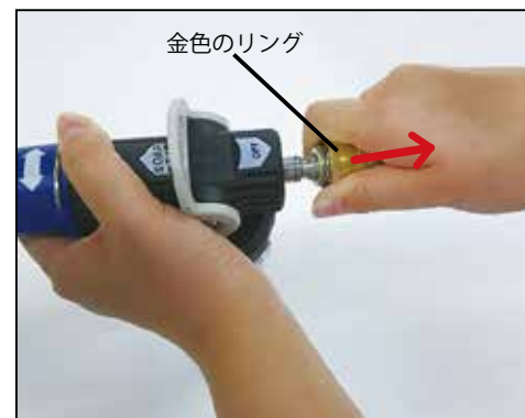
金色のリングを引ながら、本体へ押し込む
