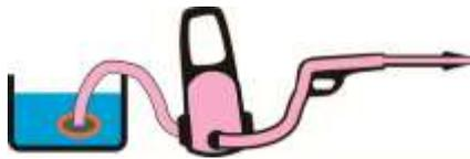
「呼び水」作業をして、全て水のみたされている状態にすると圧力が安定します。（「呼び水」作業方法はP30を参照してください。）
