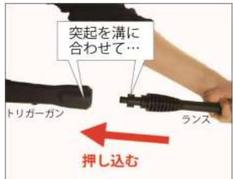
その後、ランスを、押し込みながら反時計回りに止まるまで回します。ランスを引っぱり、本体から抜けない事を確認します。
