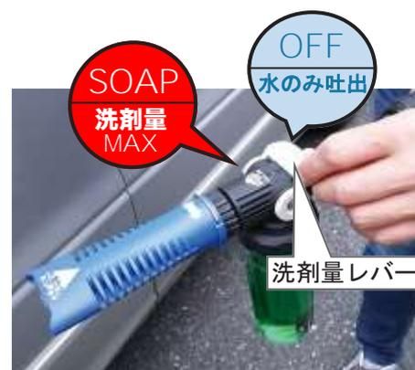
最初、洗剂量レバーはOFFの位置にしておき、噴射しながら動かして調整する
