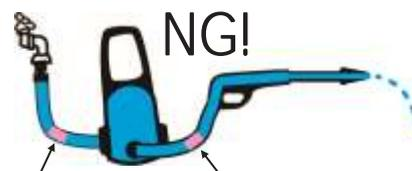
ご使用前に「空気抜き」作業をして頂くと、ホース・本体に水のみが満たされ、安定した圧力でご使用いただけます。※ため水を吸い上げてご使用の際は、「呼び水」という作業になります。（P30参照）
