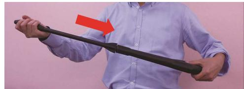
ノズルの先端を持ち、トリガーガンの溝に合わせて挿入し、グッと押し込みます。
