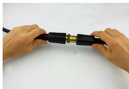
押し込んだ後に、黒いネジカバーを回して、固定します。
